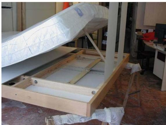
NOTE : Le tissu va continuer à se détendre un peu au cours des 2 – 3 semaines suivant la mise en tension initiale. Ceci veut dire que le plateau va s'incliner d'environ 1 à 2 cm vers le bas coté façade. Conséquence, les pieds vont toucher le sol avant que les cornières de suspension ne touchent les butées d'arrêt.
