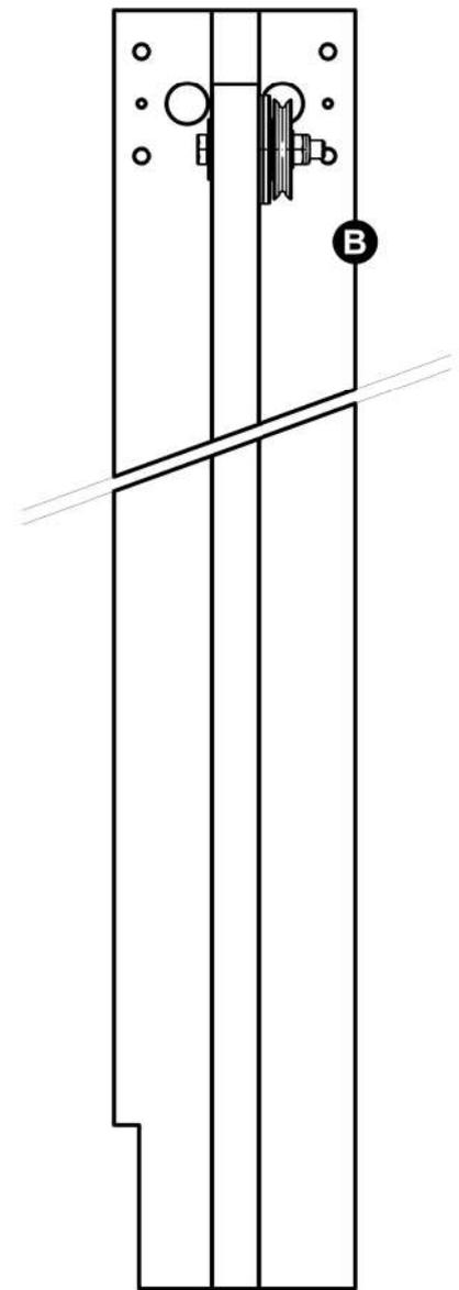
Si présence de plinthe, scier une découpe aux dimensions sur la partie arrière basse des montants.
