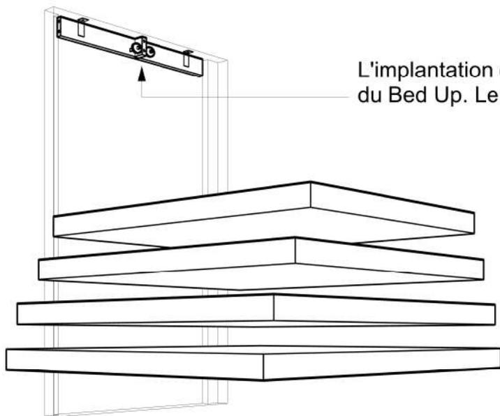
L'implantation du Support ARrière (SAR) détermine la position du Bed Up. Le SAR est centré sur toute taille de lit.
