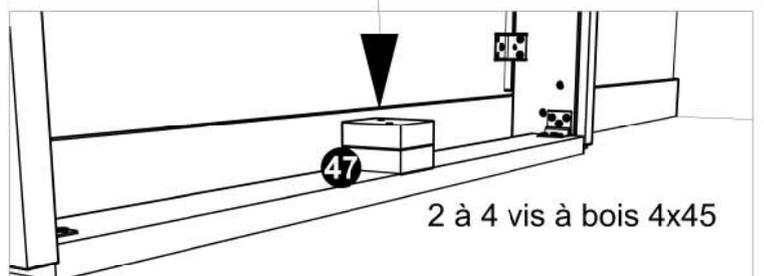
Placer 1 voire 2 cales **47** au milieu de l'écarteur pour arrêter le contrepoids au dessus de plinthe haute et installations électriques optionnelles lorsque le lit est au plafond.
