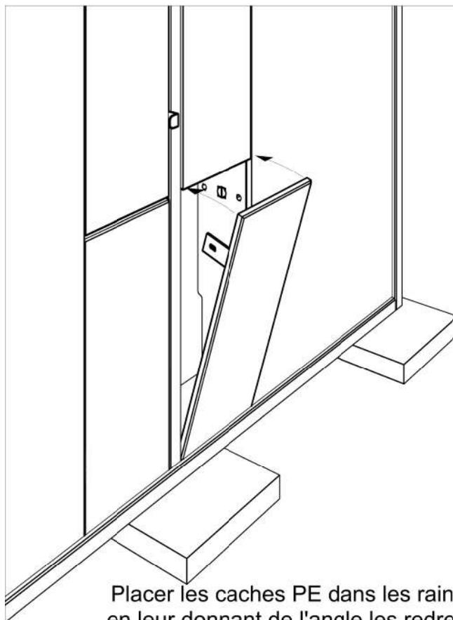
Placer les caches PE dans les rainures en leur donnant de l'angle, les redresser et finir au fond de la rainure.
