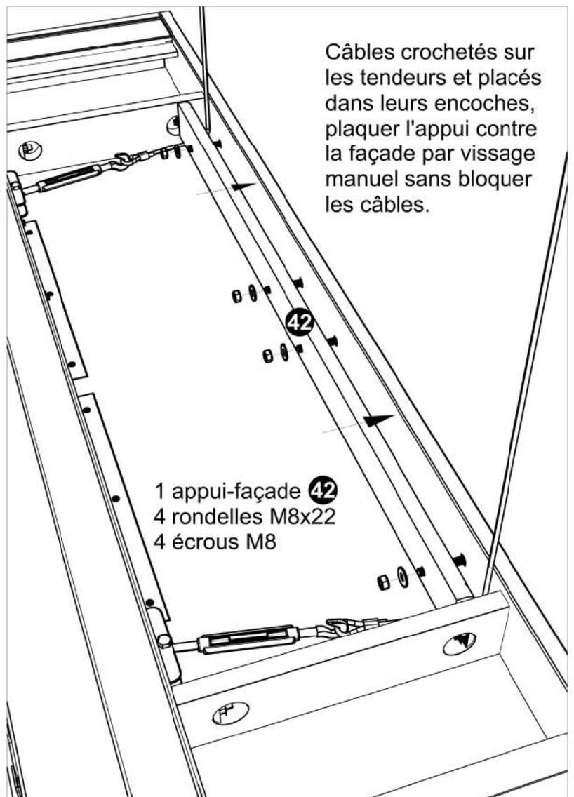
Câbles crochetés sur les tendeurs et placés dans leurs encoches, plaquer l'appui contre la façade par vissage manuel sans bloquer les câbles.
