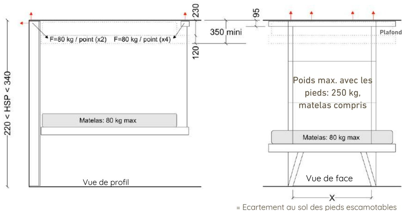
**Pieds Escamotables et hauteurs d'arrêt (en cm)** En position basse, le plateau repose sur 4 appuis: 2 butées sont intégrées dans la partie murale et 2 appuis en pieds de lit : pieds escamotables ou autre.
